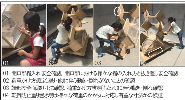
図4 搬入前シミュレーションによる安全確認
